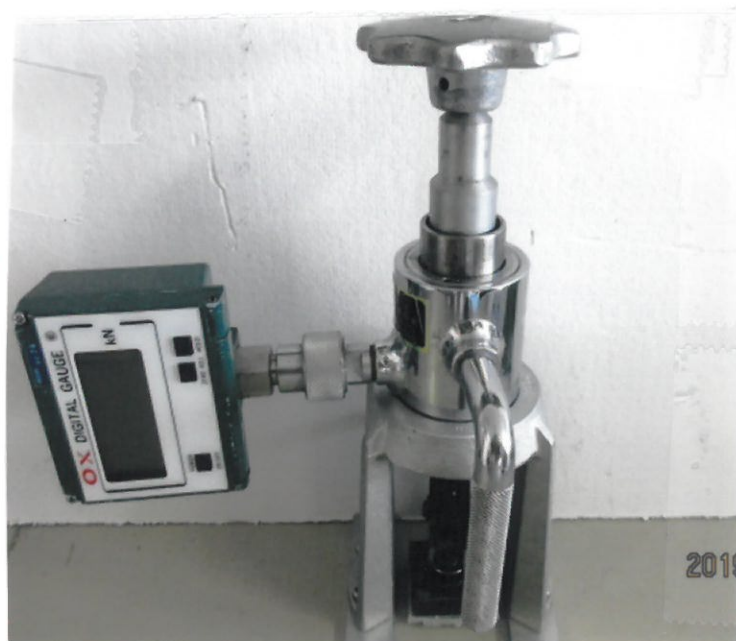
写真1) 引張試験機の外観 (デジタル加重計)
