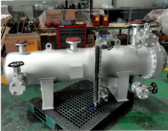
OFFGAS SEPARATOR CSEL ASME SA516-70 2118×430×1000H 単重 450kg
