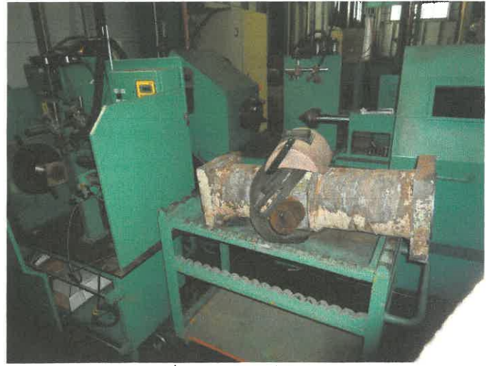
チューブ自動溶接機
