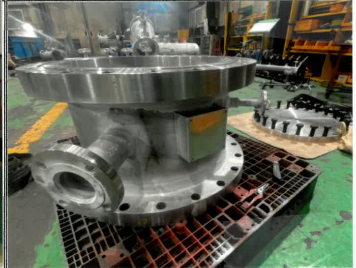
EXTRUDER VENT HOUSING SUS304 CSEL 1000×1000×500H 単重 500kg
